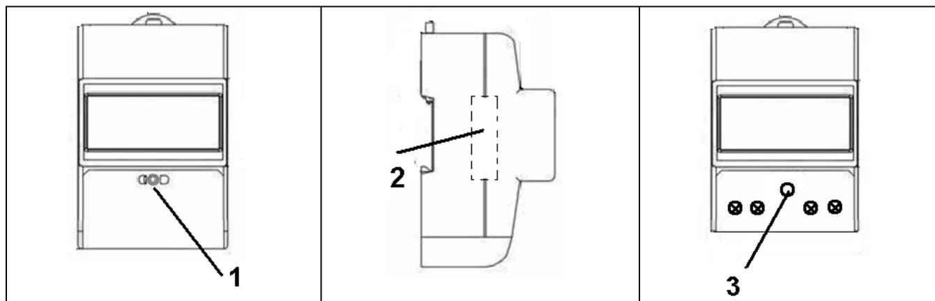
Рисунок 5 - Места пломбировки счётчика ГРАНИТ-1М, ГРАНИТ-1МЭ, ГРАНИТ-2М
