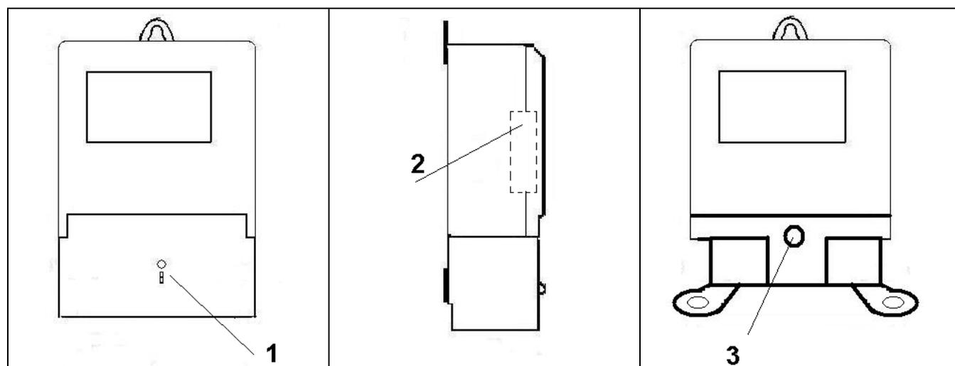
Рисунок 4 - Места пломбировки счётчиков ГРАНИТ-1, ГРАНИТ-1Э, ГРАНИТ-2
